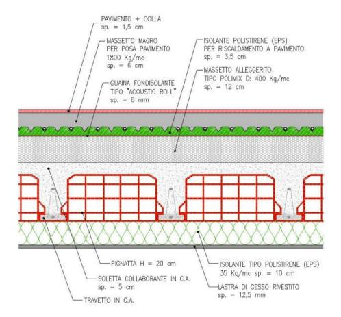
Nei piani abitativi sovrastanti locali riscaldati verrà realizzato solaio laterocementizio con intonaco civile sul lato inferiore; nel lato superiore verrà realizzato sopra alla caldana collaborante massetto alleggerito (tipo polimix), guaina fonoisolante tipo "Acoustic Roll", riscaldamento a pavimento, massetto e pavimento.
