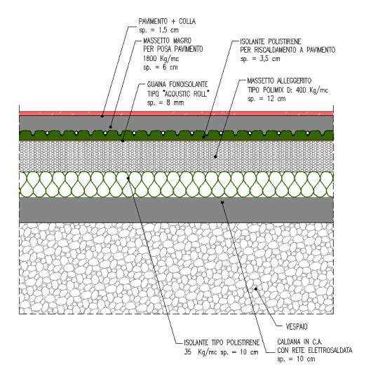
Nei piani abitativi sovrastanti locali non riscaldati verrà realizzato solaio laterocementizio isolato nel lato inferiore con materiale tipo polistirene; nel lato superiore verrà realizzato sopra alla caldana collaborante massetto alleggerito (tipo polimix), guaina fonoisolante tipo "Acoustic Roll", riscaldamento a pavimento, massetto e pavimento.
